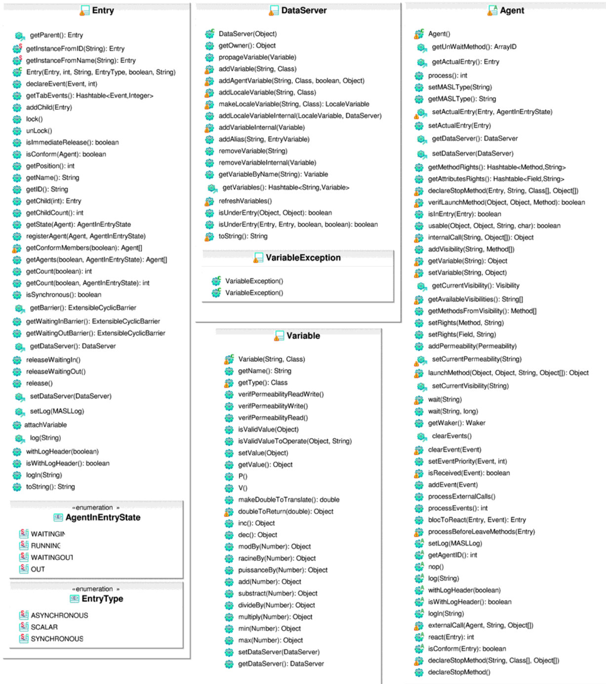
Figure 116 Diagramme de classe UML des principales classes du runtime Java
